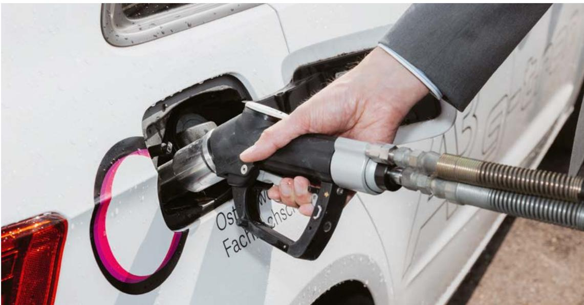
Ravitaillement en e-méthane provenant de l'installation pilote
