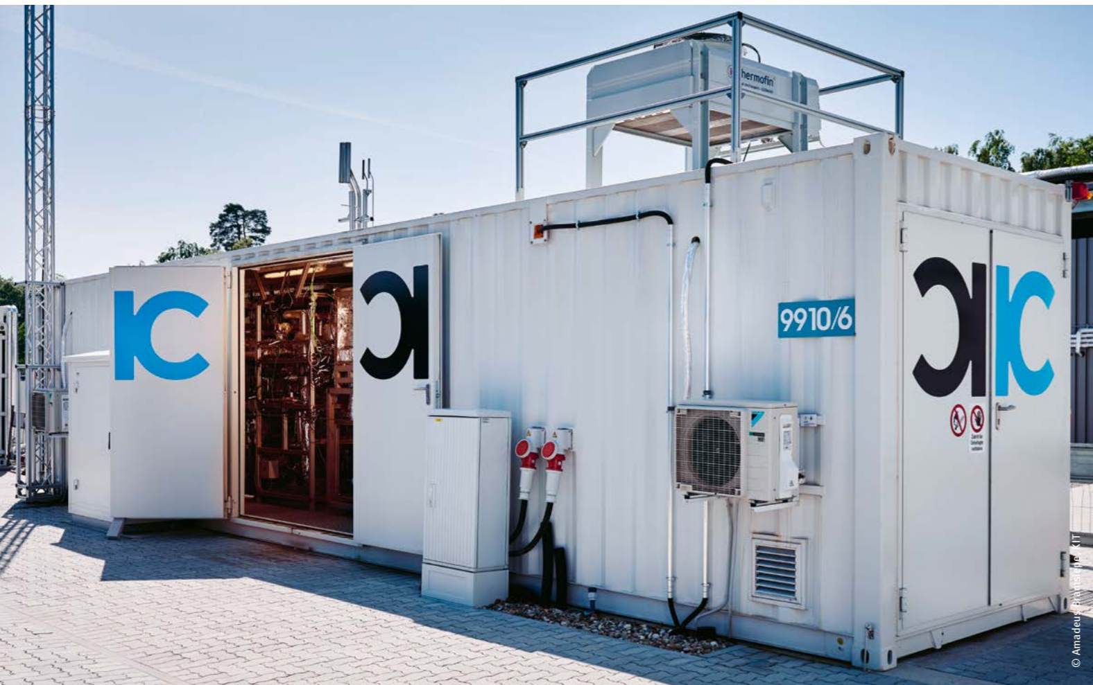
Installation pilote compacte pour la production décentralisée d'e-fuels (env. 200 litres par jour)
